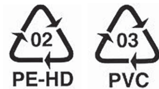
Kuva 35. Uponor Tripla-putket ja -osat on merkitty niissä käytetyn muovimateriaalin mukaisesti.
