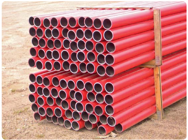
Kuva 2. Oikea tapa varastoida niput. Kehikot laitetaan päällekkäin.
